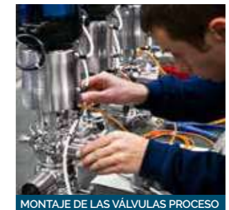
MONTAJE DE LAS VÁLVULAS PROCESO
