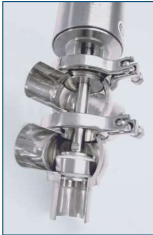
DCX4 estándar equipado de un asiento en acero inoxidable con junta de PFA flotante.
