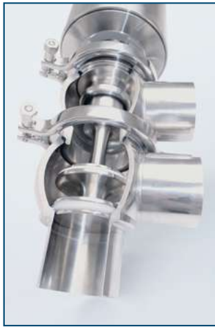
DCX4 con membrana equipada de un asiento de acero inoxidable con junta de PFA flotante y membrana de PTFE deformable.
