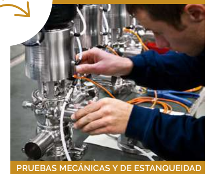
PRUEBAS MECÁNICAS Y DE ESTANQUEIDAD
