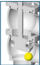
DCX4 paso de partículas VÁLVULA CERRADA
