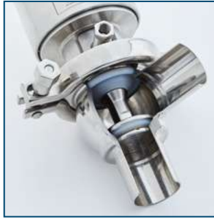
DCX3 con membrana equipada de un asiento de acero inoxidable con junta de PFA flotante y membrana de PTFE deformable
