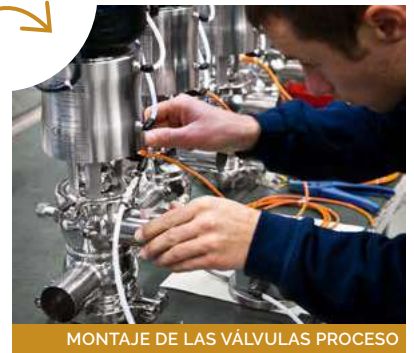
MONTAJE DE LAS VÁLVULAS PROCESO
