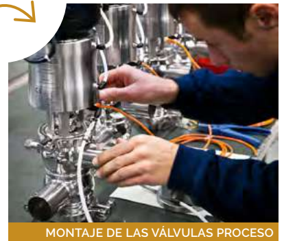
MONTAJE DE LAS VÁLVULAS PROCESO
